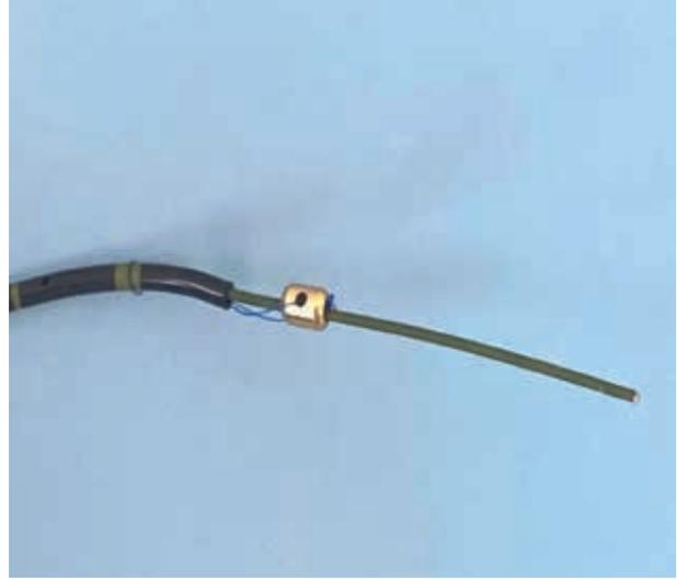
**Figura 2.** Paso del imán a través de la guía.
